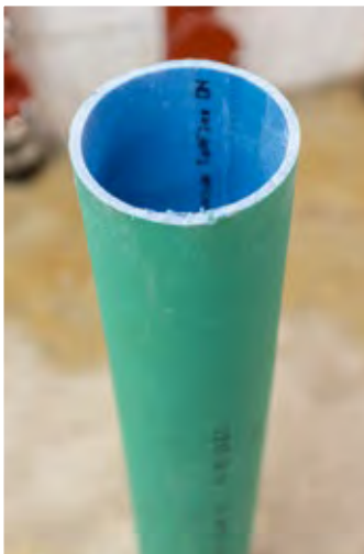
▲ Grønn/blå strøpme (strøpemetoden): nytt rør fra kummen ute og til avløpet til kommunen.
