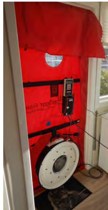
▲ TRYKKTESTING: I forbindelse med energikartleggingen gjøres det en trykktesting for å avdekke luftlekkasjer.
